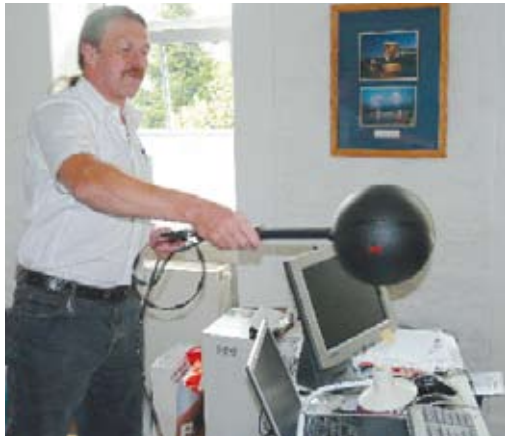
Mess-Spezialist Thomas Linner bei der HF-Messung am PC-Arbeitsplatz mit klar erkennbaren unterschiedlichen Werten bei eingeschaltetem WLAN und DECT-Telefon (rechts oben) bzw. ausgeschaltet (darunter)
