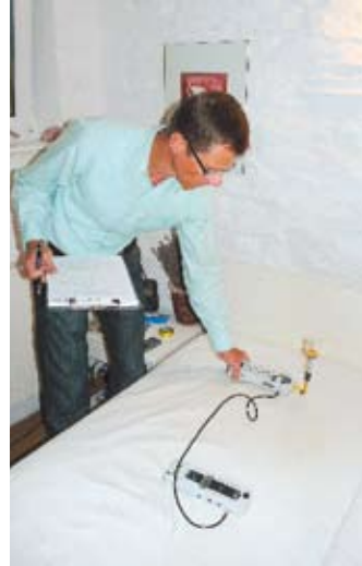
Oben: Auch beim Schlafplatz wird alle 10 cm das statische und das ELF-Magnetfeld gemessen. Zu hohe Unterschiede stören die Regeneration beim Schlafen – ähnlich wie zu hohe HF-Werte (Mitte), die allerdings in diesem Falle nicht vorhanden waren
