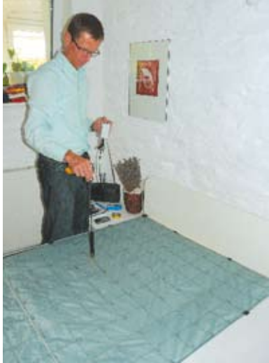
Oben: Auch beim Schlafplatz wird alle 10 cm das statische und das ELF-Magnetfeld gemessen. Zu hohe Unterschiede stören die Regeneration beim Schlafen – ähnlich wie zu hohe HF-Werte (Mitte), die allerdings in diesem Falle nicht vorhanden waren
