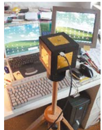
Rechts – Bildfolge von oben nach unten: Das elektrische NF-Wechselfeld am Arbeitsplatz wird in Kopf- und Sitzhöhe sowie am Boden gemessen – ebenso das magnetische NF-Feld mittels Messwürfel (Bild Mitte)
